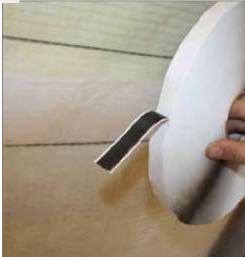
1. Використовувати двосторонню бутилкаучукову стрічку
